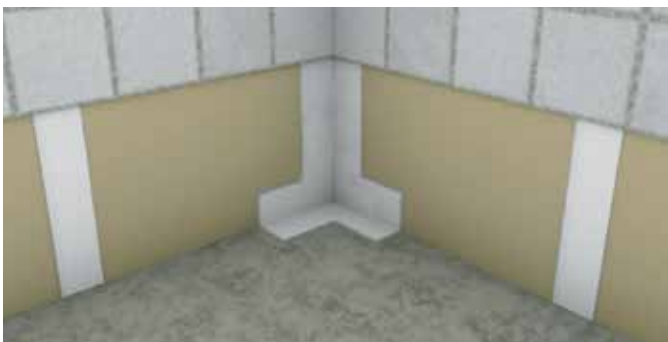
3. Vedeneristenuha 3627/3628 käsitellään SCHÖNOX HA / Casco AquaStop -vedeneristeellä.
